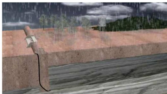
Após a definição do local, é necessário abrir algumas trincheiras (buracos de postes) até a camada impermeável do solo ao longo da linha, onde será construída a parede. Essa etapa serve para conhecer a profundidade do solo, pois a profundidade geralmente não é uniforme e permite, também, localizar as ombreiras (solos mais rasos), pois esta é de grande importância para evitar que a água se perca pela lateral (Figura 2).
