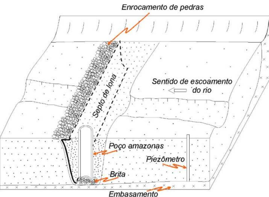
Para evitar problemas dessa natureza recomenda-se colocar um tubo de descarga de fundo, sobre a camada impermeável, partindo da montante, perfurando a parede até a jusante, onde nesta extremidade, coloca-se uma curva 90o com um outro tubo na vertical que funcionará como um poço, podendo esta água ser bombeada ou escoar sobre o solo. Este tubo permite anualmente a lavagem do perfil do solo carreando os sais dissolvidos na água da barragem.
